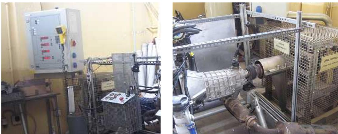
**Figura H.1** Banco de pruebas para motores (medidor de torque y potencia).
