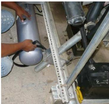
**Figura 3.15** Fijación del tanque de almacenamiento de GLP en el motor carburado.
