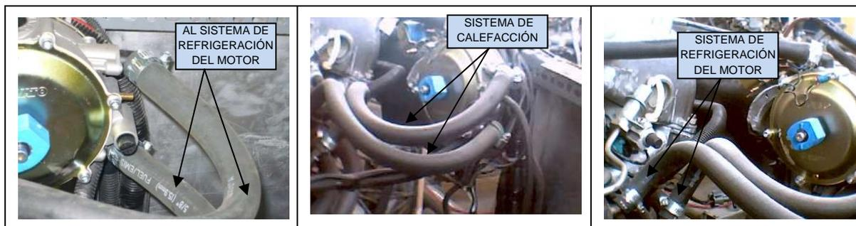
**Figura 3.32** Instalación del circuito de calefacción en el motor a inyección electrónica.
