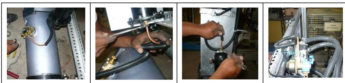
**Figura 3.31** Proceso de instalación del circuito de alta presión en el motor de inyección electrónica.
