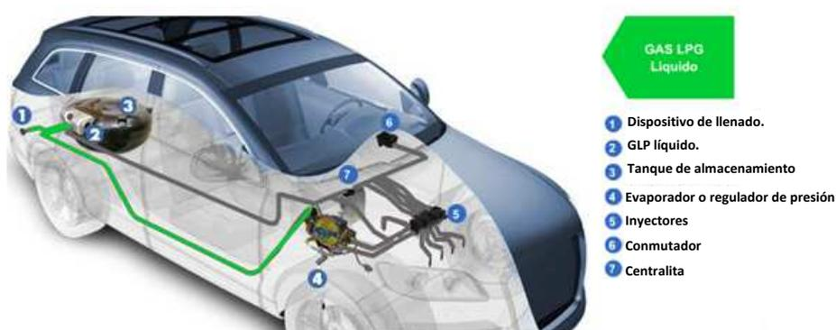
**Figura 2.9** Recorrido del GLP líquido hasta el evaporador o regulador de presión (circuito de alta presión) <sup>45</sup>.
