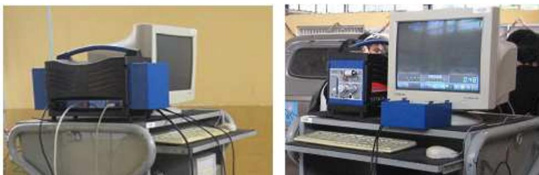
**Figura G.1** Equipo analizador de gases de escape MAHA MGT5.
