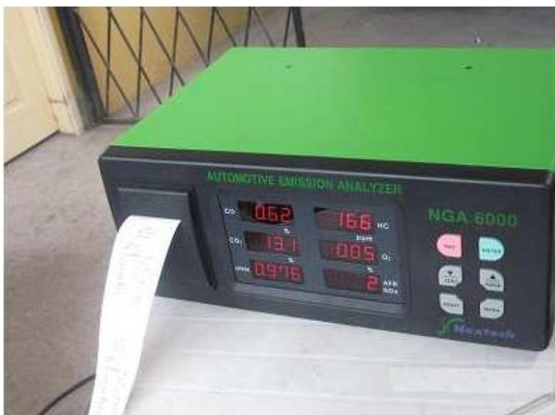
**Figura G.2** Equipo analizador de gases de escape Nextech NGA 6000.
