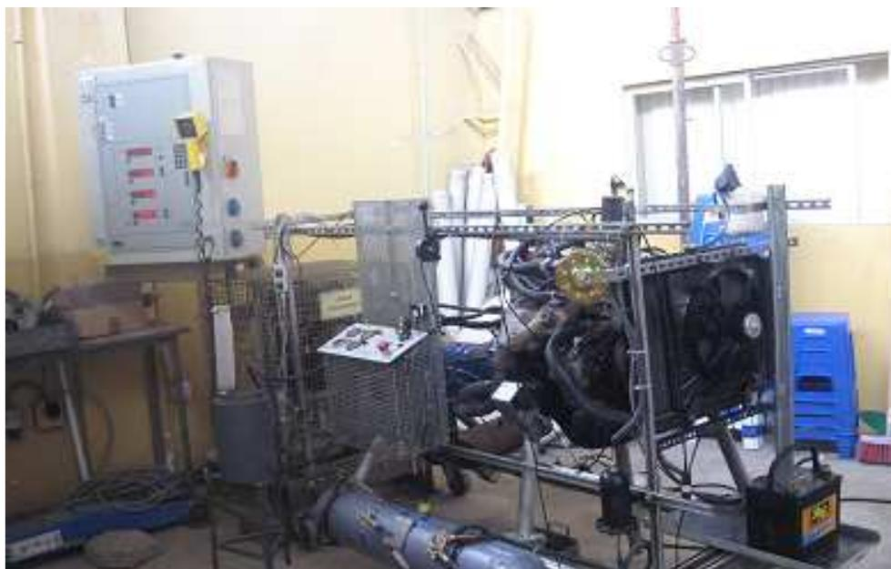
**Figura I.1** Adaptación del motor a carburación con el banco de pruebas para medir la potencia y el torque.
