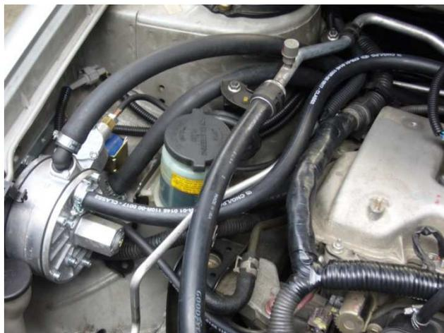
**Figura 2.12** Ejemplo de instalación de un regulador de presión en un Toyota COROLLA<sup>48</sup>.
