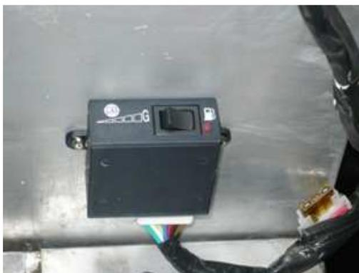
**Figura 3.33** Instalación del conmutador en el motor de inyección electrónica.
