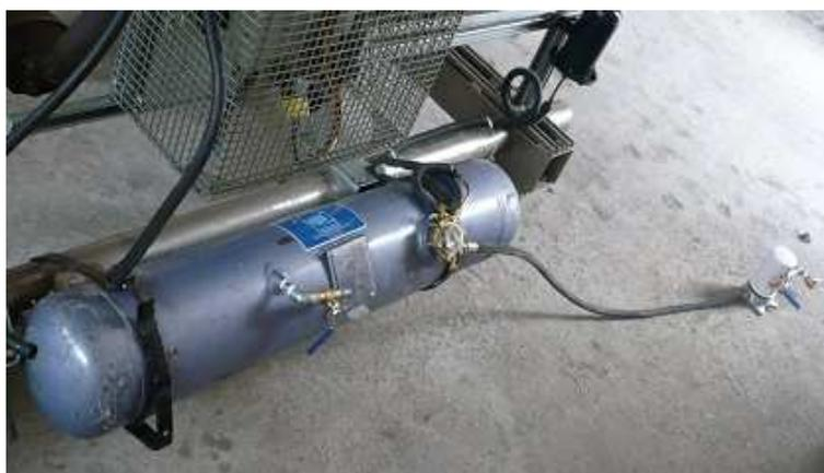
**Figura 3.19** Multiválvula y sistema de carga de GLP en el tanque de almacenamiento del motor carburado.
