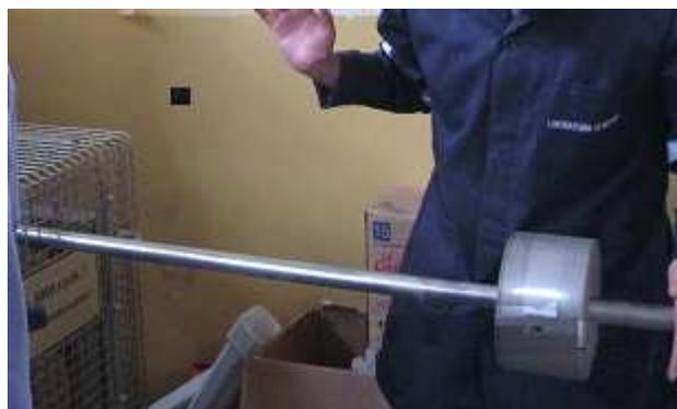
**Figura H.2** Palanca de calibración 250 Nm.
