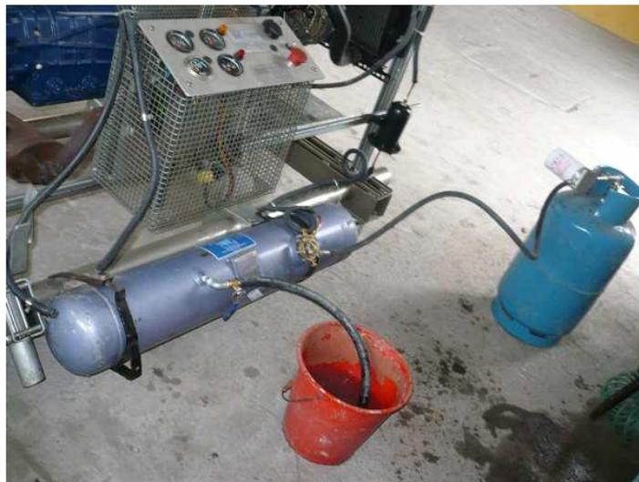
**Figura 3.40** Proceso de carga de GLP en el tanque de almacenamiento de los motores a carburación e inyección electrónica.
