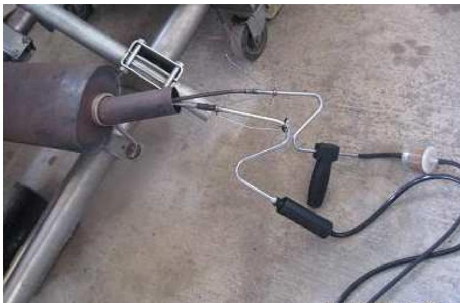
**Figura I.3** Ubicación de las sondas del equipo MAHA y Nextech en el tubo de escape del motor a carburador, para medir las emisiones de gases.
