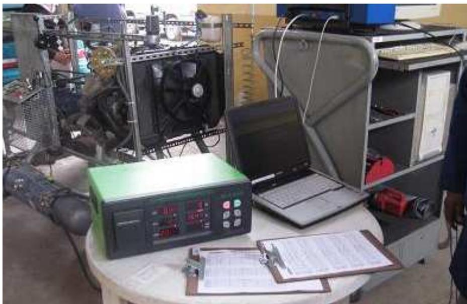
**Figura I.2** Instalación de los analizadores de gases MAHA MGT5 y Nextech NGA 6000 en el motor a carburador.
