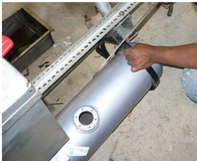
**Figura 3.29** Fijación del tanque de almacenamiento de GLP en el motor a inyección electrónica.
