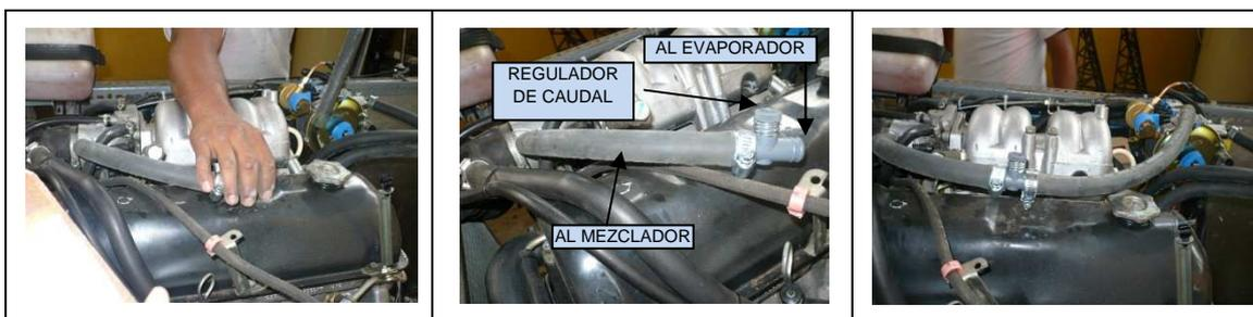
**Figura 3.27** Proceso de instalación del circuito de baja presión en el motor a inyección electrónica.
