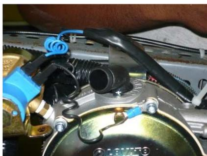
**Figura 3.12** Conexión eléctrica de la electroválvula.
