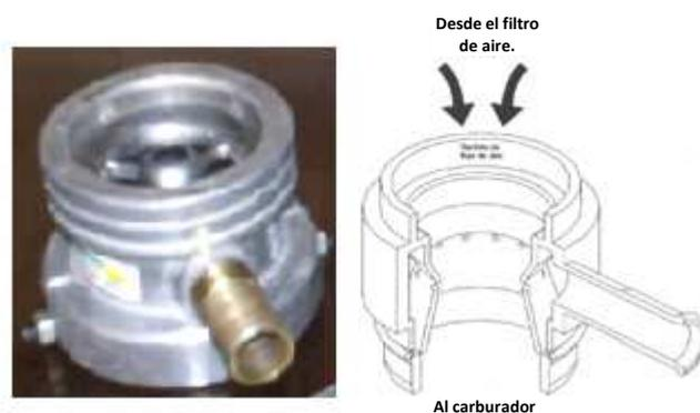
**Figura 2.14** Esquema de un mezclador para un motor carburado<sup>49</sup>.
