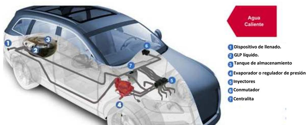
**Figura 2.10** Paso de fase líquida a fase gaseosa del GLP en el evaporador o regulador de presión<sup>46</sup>.
