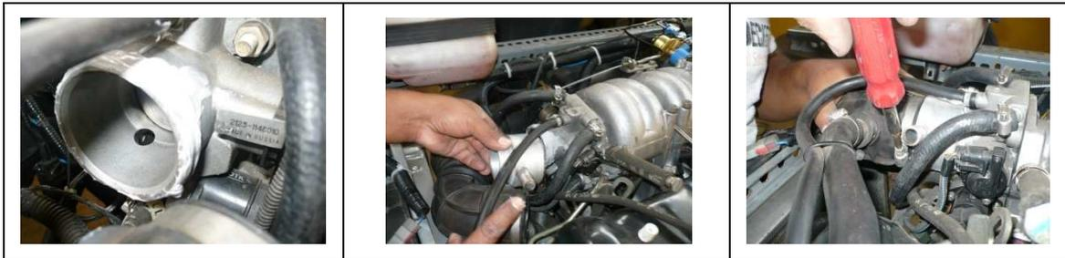
**Figura 3.28** Proceso de Instalación del mezclador en el motor a inyección electrónica.
