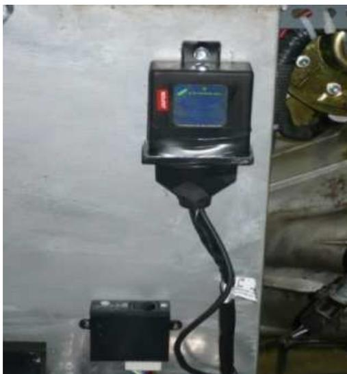
**Figura 3.36** Instalación del emulador de inyectores en el motor de inyección electrónica.
