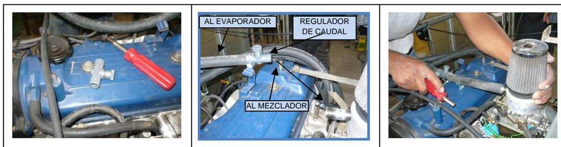
**Figura 3.13** Proceso de instalación del circuito de baja presión en el motor a carburación.
