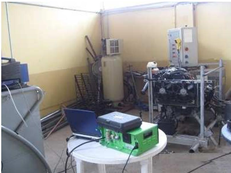
**Figura J.2** Instalación de los analizadores de gases MAHA MGT5 y Nextech NGA 6000 en el motor a inyección electrónica.
