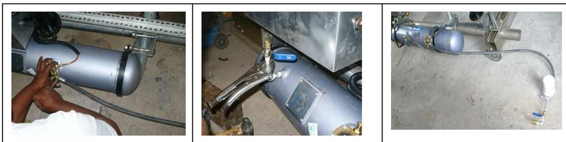
**Figura. 3.30** Instalación de la multiválvula y sistema de carga de GLP en el tanque de almacenamiento del motor a inyección electrónica.
