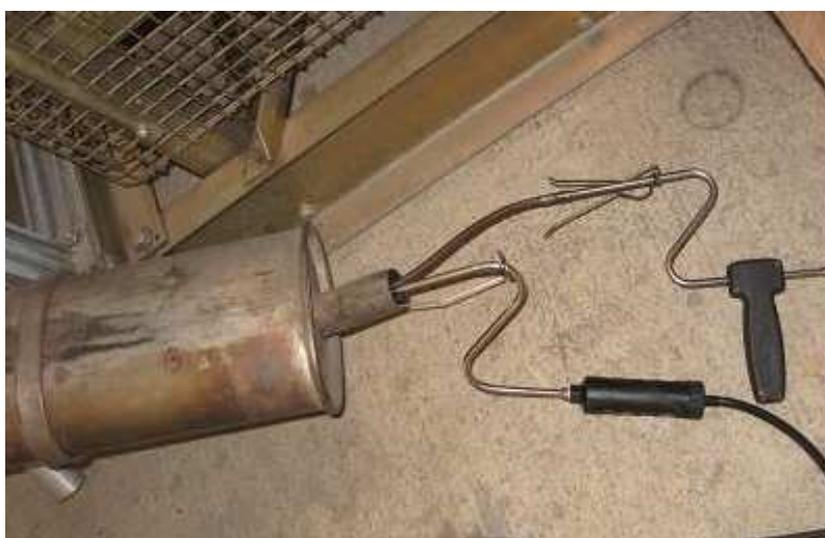
**Figura J.3** Ubicación de las sondas del equipo MAHA y Nextech en el tubo de escape del motor a inyección electrónica, para medir las emisiones de gases.
