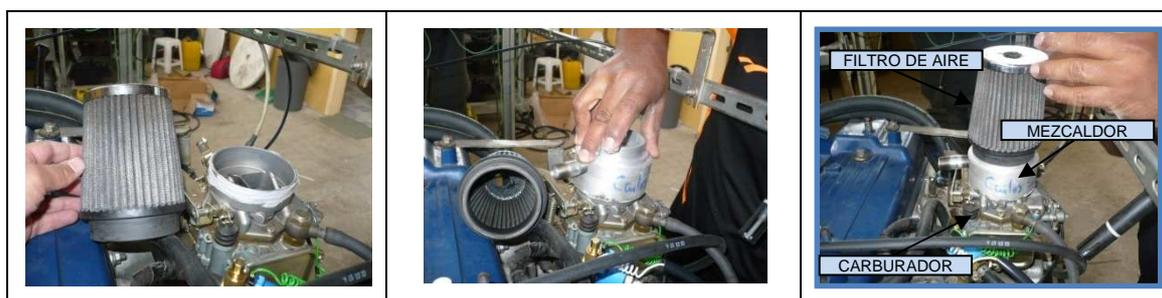
**Figura 3.14** Proceso de instalación del mezclador en el motor a carburación.
