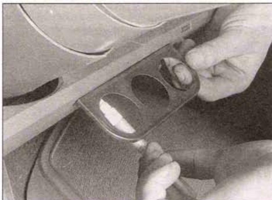
7.26 Coloque el soporte de montaje donde desea ponerlo y usando los orificios de montaje en el soporte como una plantilla, marque los orificios que desea perforar con una pluma para marcar
