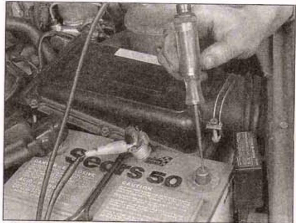
5.17 Conecte una luz de prueba entre el poste negativo de la batería y el cable negativo de la batería
