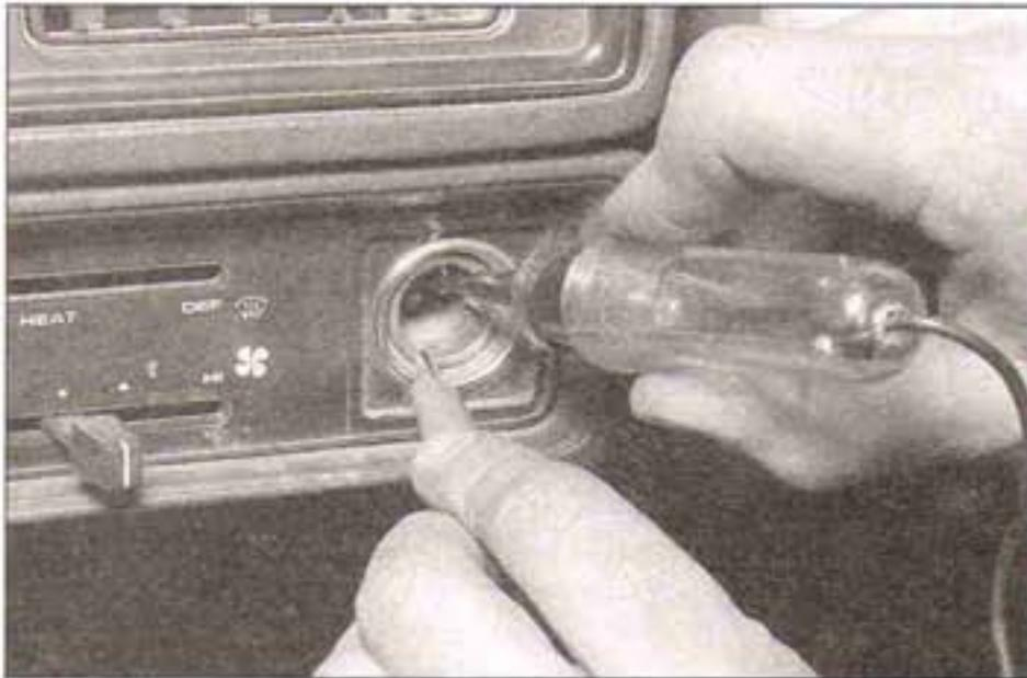
8.2 Pruebe con la sonda el terminal central en el receptáculo del encendedor, con una luz de prueba
