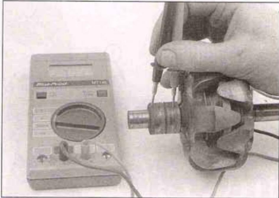
5.57 Compruebe si hay continuidad entre los dos anillos resbaladores. De no ser así, el rotor estará abierto y será necesario reemplazarlo
