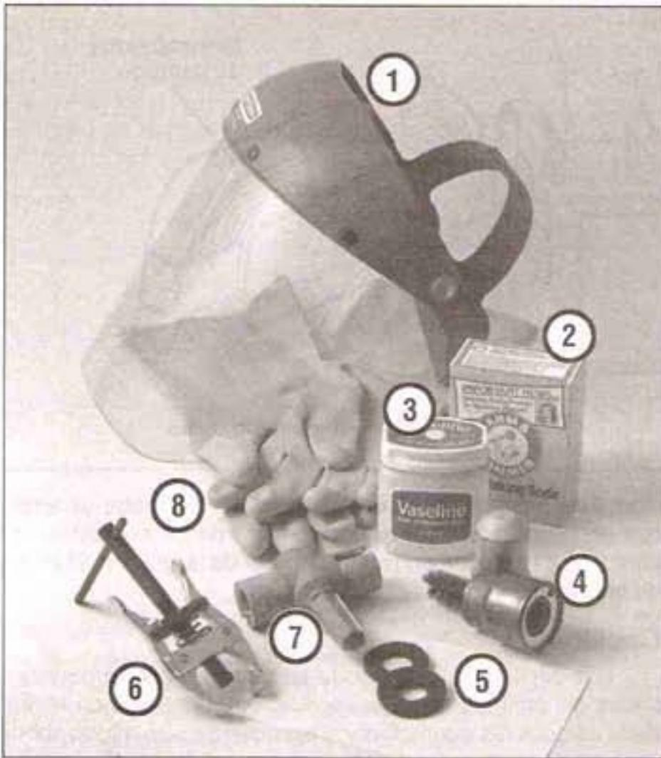
**4.11 Herramientas y materiales necesarios para el mantenimiento de la batería**
