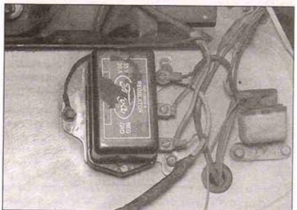
5.25 Este es un regulador de voltaje de un generador típico con tres conexiones para los cables y tres pernos de montaje
