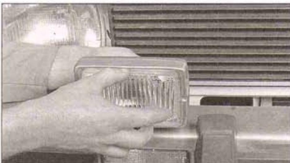
6.34 ... luego monte las luces usando el equipo y accesorios suministrado en el juego. Si su juego sólo tiene un alambre que va a cada luz (significa que la luz está conectada a tierra donde se monta), asegúrese de que el montaje hace buen contacto eléctrico con la carrocería. En este caso, si estuviéramos usando luces de sólo un alambre, desearíamos chequear la continuidad entre el guardafangos y la carrocería y añadir una correa de conexión a tierra, si fuera necesario
