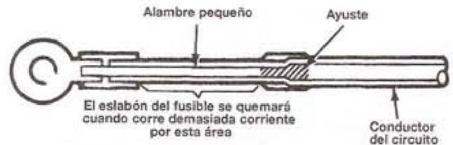
1.33 Diagrama del eslabón del fusible típico
