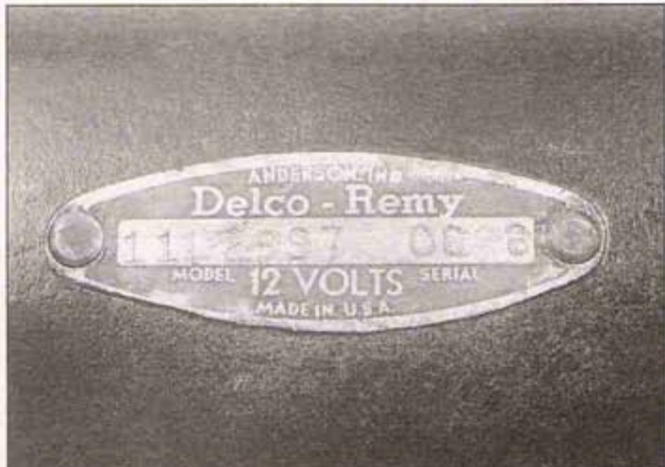
5.28 Etiqueta de identificación típica de un generador
