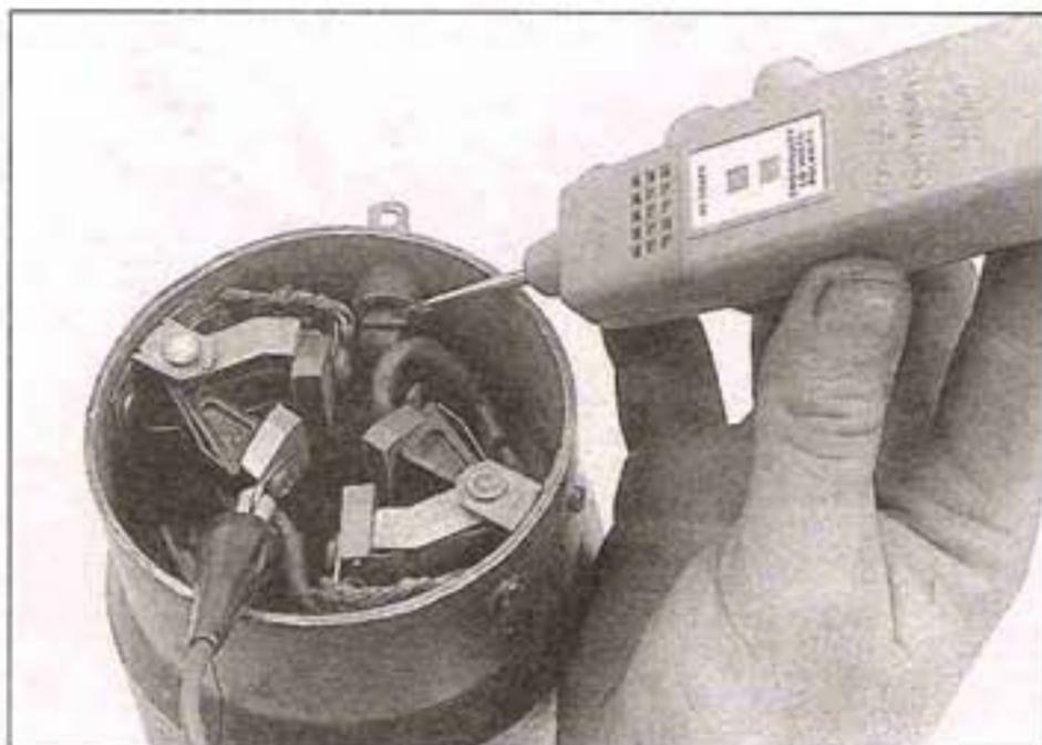
4.96 Chequeando por un abierto en los embobinados de campo
