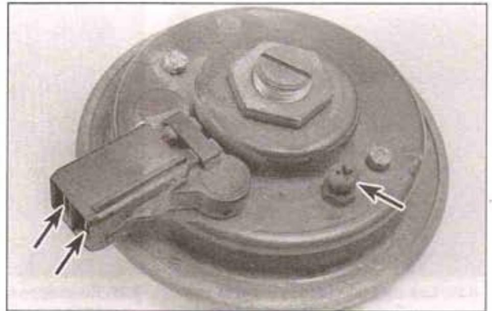
8.29 Bocina típica tipo sin relé, mostrando sus dos terminales y tornillo de ajuste (flechas)
