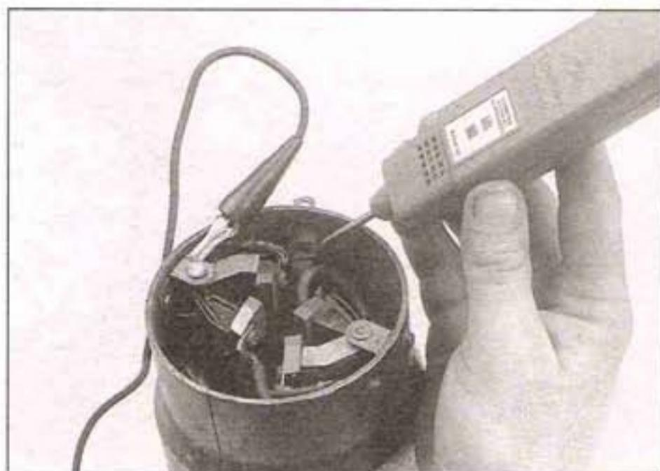
4.97 Chequeando un embobinado de campo conectado a tierra
