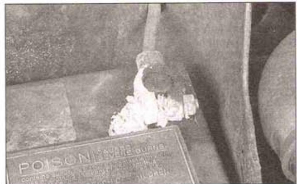
1.14 La corrosión como ésta que se forma en los terminales de la batería puede causar resistencia suficiente como para impedir que el vehículo se encienda - siempre asegúrese cuidadosamente que no haya corrosión, que las conexiones no estén sueltas ni desgastadas o que no hayan alambres parcialmente dañados cuando sospeche de una resistencia excesiva en algún circuito
