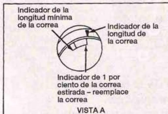
5.7 En algunos modelos, la correa se tensiona automáticamente y no es necesario realizar ningún mantenimiento mientras esté en buena condición y el indicador esté en el rango adecuado
