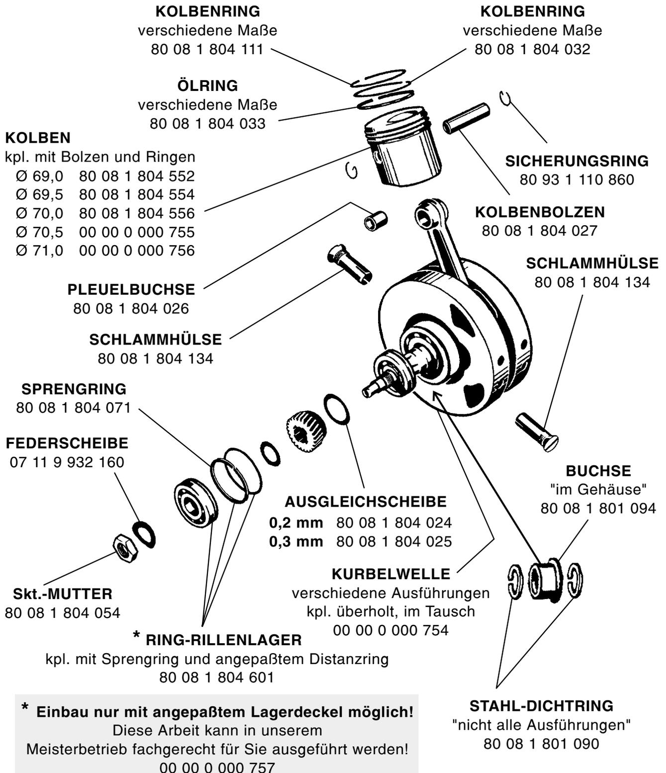
**Bei der NSU-MAX wurden werkseitig 10 verschiedene Ausführungen von Kurbelwellen verwendet (Serien-/Austausch-/Reparatur-Ausführung). In der Regel können wir alle gängigen Ausführungen ab Lager liefern. Bei allen nicht lagermäßig vorhandenen Ausführungen werden die eingeschickten Wellen entsprechend überholt!**
